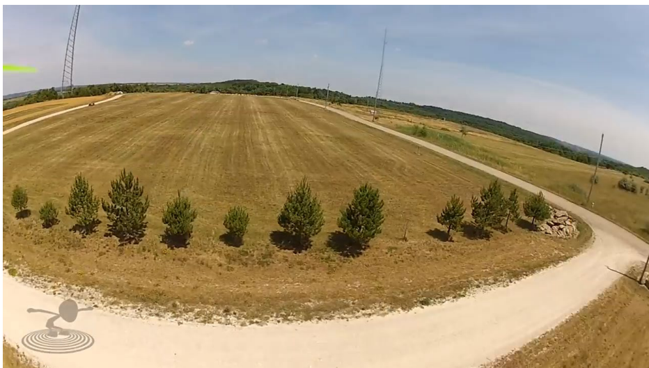
图像质量变差: jello-like(果冻), wavy (波纹), warped (弯曲)
